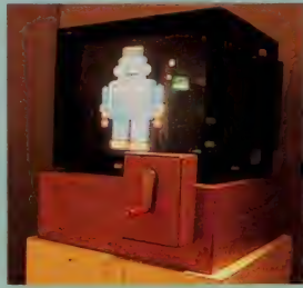
◆観客の回すハンドルのスピードにあわせて画面のロボットが歩き、「マン・マシン・TV No.5」。手足の部分以外はスクロールさせて、よりリアルに見せている。
