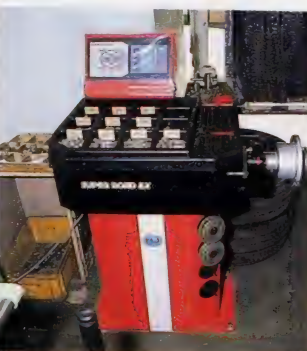
●これが、従来のホイールランサー。ほとんどの振動は、これを使うことで解消されるということだった。
