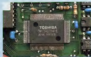
▲これがMIDIインターフェースの心臓部、84C015というLSIなのだ。
