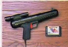
◆アスキー製の光線銃。ジョイスティックポートに接続して使用。新しいゲームの世界を開いてくれるね
