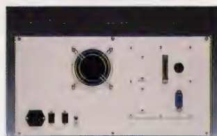
◆これが裏側。大きな冷却ファンが過酷な状況下でも安定した動作を保证する。
