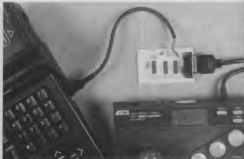
◆完成したものを実際に接続してみた。このようにして、ファミコン用のジョイスティックを使えます。
