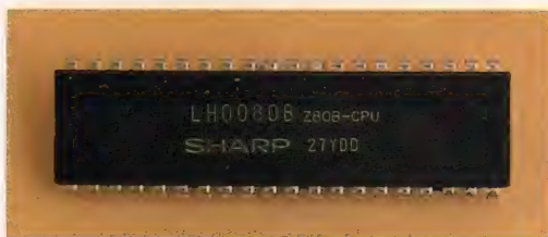
◆Z80B、Z80Aをハンダ吸い取り線を使って取りはずしたのち、これを取りつける。
