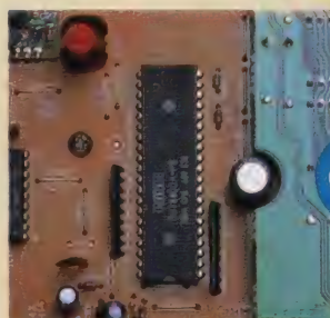
◆改造前のCPU付近。慎重にハンダを吸い取って、Z80Aははずします。
