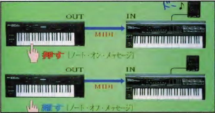
★キーボードの鍵盤を押した時点で、MIDIのOUT端子からは、ノートオンのメッセージが出力される。そして、離れたときには、ノートオフのメッセージが流れるのだ。
