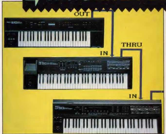
●OUTからINIに、そしてTHRUからまた別の音楽のINIに。MIDIのこのようなつなぎ方は、3系統くらいが限度である。それ以上ふやすと、誤動作の危険性があるのだ。
