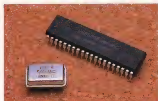
◆今回使う部品のZ80Bと6MHzのオシレータ。これだけで1.5倍のスピードに。
