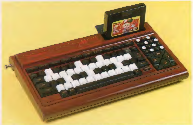
●これが、手作りMSXシンセサイザー。なんとFM音源を搭載で、ポリフォニック演奏が可能なのだ!
