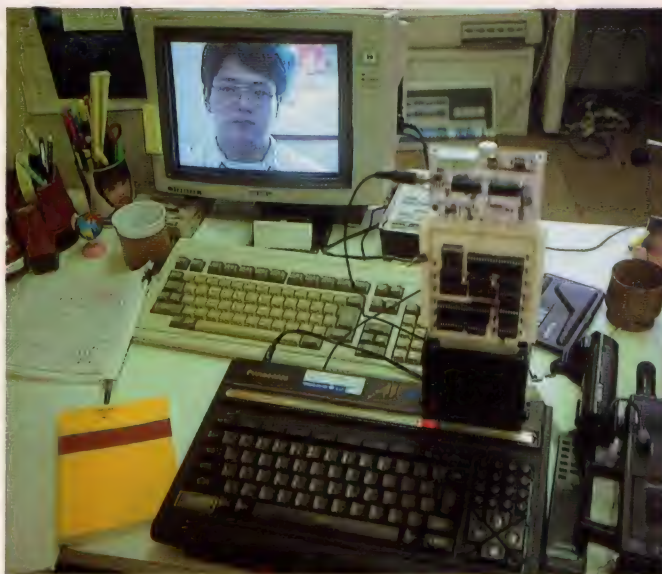
◆MSX2+用、画像取り込みユニットの試作品実験風景。背高ノッポのカートリッジは配線ビッシリの手作りの品。さて、このユニットが正式に発表されるのはいつ？
