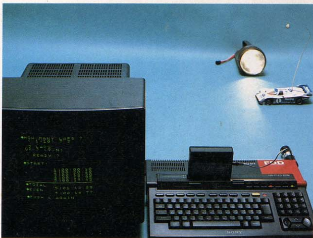
▲テストに使用した機材はMSX2本体とモニター、センサーキッド(6,800円)。それと東急ハンズ渋谷店で購入したハロゲンランプの懐中電灯(2,700円)だ!!
