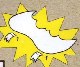
③のりしろを折り、フラップの先を曲げて、主翼の左右の前(中央)に接着します。
