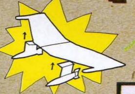
③のりしろを折り、主翼の左右の中心部分に接着します。
