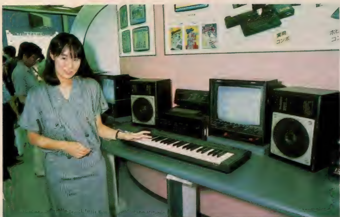
◆初登場のA1シンセ、話題のMSX-Audioを製品化したもので、FM音源に迫るカタログデータを示している。
