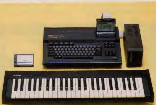
本体にSFGをすっきり内蔵させ、ミニキーボードとディスクを付けた標準的なシステム。
