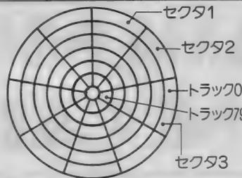
MSXでは、フロッピーディスクをサーフェス、トラック、セクタに分けて使います。ディスクの表裏がサーフェス、円周がトラック、そしてこれらを放射状に分割したものをセクタと考えます。なおサーフェスは0~1(1DDタイプは0のみ)、トラックは0~79、セクタは1~9(1トラック8セクタの場合は1~8)というように、番号が付けられています。
