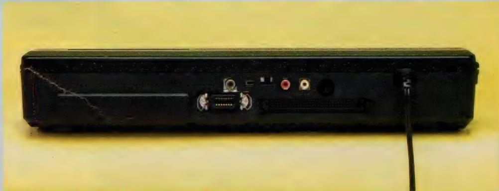
◆後面スロットに蓋をしてみると、リアパネルはこのようにスッキリする。音声/映像出力はおなじみの3方式
