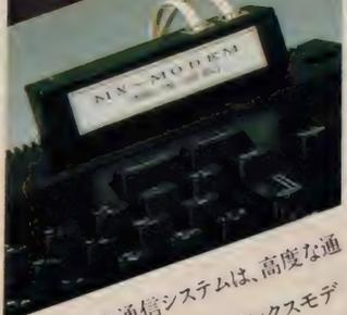
ザ・リンクスの通信システムは、高度な通信ソフトをROMに搭載したリンクスモデムを、あなたのパソコン本体(MSX)に差込み、家庭の電話に接続するだけの簡単なシステムです。従来のカプラーを使うシステムと比べて、RS232Cインターフェイスを不要とし、価格は約1/2と大幅に安く、通信スピードは4倍の1200bpsと高
