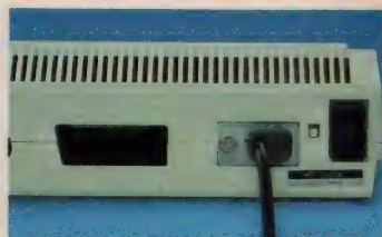
◆アナログRGB21ピン端子と、AC100ボルトの電源コンセント。ディスクやモニタをつなぎます。
