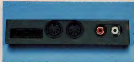
◆キーボード接続端子と、MIDIのイン、アウト。そしてサウンド出力。◆◆SFG-05の設定画面。非常に見やすくなっている。
