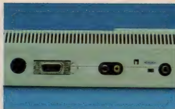
◆左からカセットIF、プリンターF、コンポジット出力、RF出力。放熱のためスリットが切られている。
