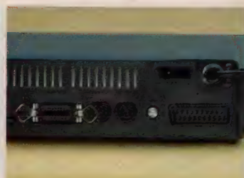
◆左から順に、リセットスイッチ、プリンタ1F、カセット1F、ビデオ出力、アース端子、RGB出力。
