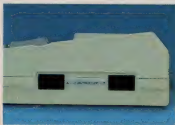
◆右サイドにあるジョイスティックポート。上に出ているのは、電源部だと思われる。
