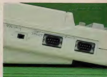
◆タブレットを使うときは、タブレットスイッチを“入”に。ジョイスティックのポート2を共用している。
