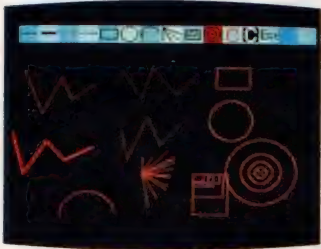
◆ポイント・モードによる図形表現。細線、太線、点線などによる線分の他、放射線、アーク、同心円などの表現も可能。
