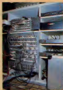
◆ラックにしっかりと組み込まれたエフェクター。左側のコードが差し込まれたものが自作のバッチペイ。このスタジオのキーボード類をスッキリまとめるものだ。
