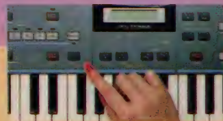
◆前面パネルのボタンでMIDIの1~16チャンネル(送受信)とポリモード/モノモード(オムニオン/オフは無視)を設定することができる
