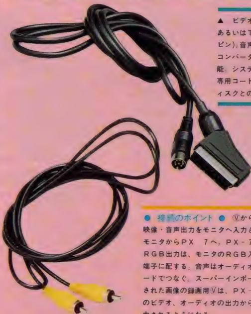
▲ビデオ出力は、コンポジット、あるいはTTLレベルのRGB(8ピン)。音声出力はステレオ。外部コンバータを介してRF出力も可能。システムコントロール端子は専用コードを使用し、レーザーディスクとの接続が可能になる。
