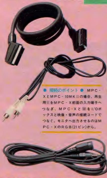
● 接続のポイント ● MPC-XとMPC-10MK IIの場合、再生用VをMPC-X前面の入力端子へつなぎ、MPC-XとMをI/Oボックスと映像・音声の接続コードでつなぐ。モニターへ出力させるのはMPC-XのRGB(21ピン)から。
