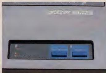
↑本体上面の操作パネル。紙がなくなるとブザーが鳴り、アラームが点滅する。←乾電池で駆動するのが、HR-6Xのすごいところ。→後方につき出しているのが漢字ROMカートリッジ。その隣りにプリンタインターフェイス、上にセットしたのがロール紙ホルダー。
