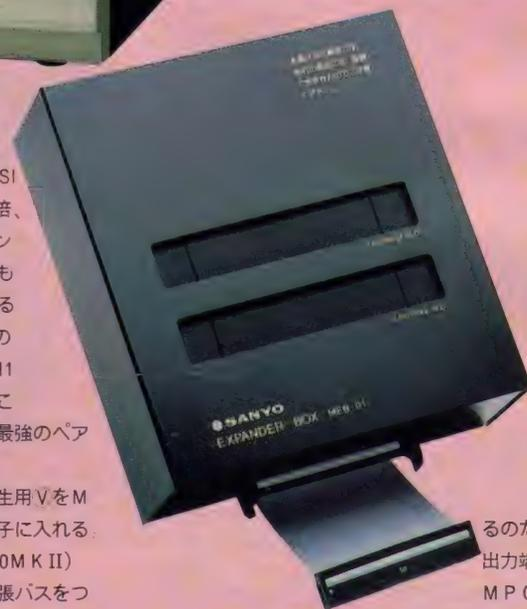
ろがこの心配も、ツイにサンヨーユニットコネクタ(KA-UC-X)によって解決されることになった。これは、WAVYシリーズ以外のMにMPC-Xを接続する際に、スロットを使って拡張I/Oボックスとつなげるようになっていた。サンヨーのPA企画部に問い合わせれば作ってもらえ
