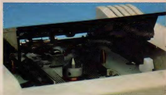
**カ**セットテープは手軽で使いやすいけど、長いプログラムのロード・セーブには時間がかかり過ぎるのが難点。それに信頼性という面でも弱いところがある。その点フロッピーディスクは機能豊富で申し分ないのだけど、高価なため、そうそうは手が出ない。そこで考え出されたのがクイックディスク。カセットとフロッピーの中間に位置するマシンだ。クイックディスクの特長は、カセットと較べてデータの読み書きが早い
