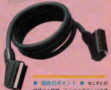
● 接続のポイント ● モニタとの接続は4種類。①ふつうのテレビの場合(75Ω外部アンテナ端子付き)、②前面にRF(Hit)端子のついたテレビの場合、③映像・ステレオ音声入力端子付きテレビの場合、④アナログRGB(21ピン)端子付きテレビ、またはカラーモニタの場合。
