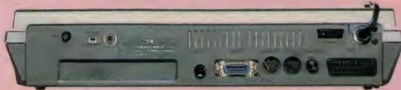
◀映像出力は、アナログRGB(21ピン)、コンポジット、RFの3出力。アンテナ端子、映像・音声入力端子付のテレビに接続するための、それぞれ専用の接続ケーブルが付属されている。背面はこの他に音声ミキシングボリュームと色相調整ツマミがある。
