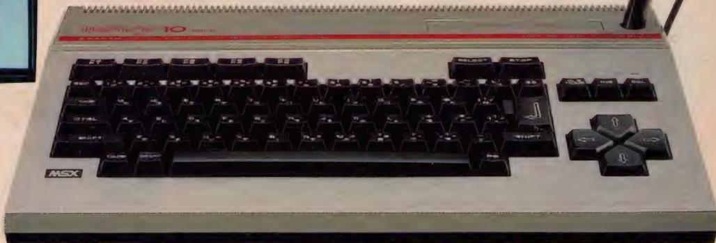
＜WAVY10mkIIの主な仕様＞ ●CPU…Z-80Aコンパチブル ●ROM…32KB(MSX-BASIC)+8KB(ライトペンソフトROM) ●RAM…32KB+VRAM16KB ●表示能力…テキスト表示:40字×24行(32字×24行)、グラフィック表示:256×192ドット・16色、スプライト機能:32面 ●キーボード…英数字、ひらがな、カタカナ、グラフィック記号、アイウエオ配列、73キー ●サウンド機能…8オクターブ、3重和音+効果音 ●画像出力…RF信号・コンポジットビデオ信号 ●カセットインターフェース…FSK方式、1200・2400ボー ●プリンターインターフェース…8ビットパラレル(セントロニクス社仕様) ●ジョイスティック端子…2 ●カートリッジスロット…1(MSX仕様) ●I/O拡張バス…50PIN ●電源・消費電力…AC100V(50/60Hz)・10W ●寸法・重量…385(W)×62(H)×242(D)mm・2.2kg
