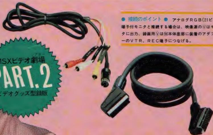
● 接続のポイント ● アナログRGB(21ピン)端子付モニタと接続する場合は、映像源のVはモニタに出力、録画用Vは本体底部に装着のアダプターのVTR、REC端子につなげる。
