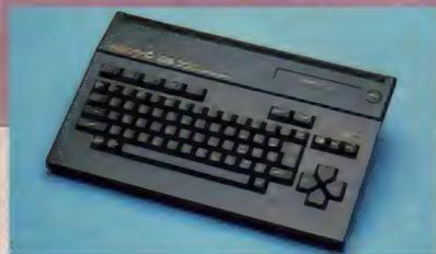
サンヨーのWAVYシリーズに加わったニューフェイス。RAMは64キロバイト実装され今後の拡張に備える。ボディモールド、キーボードなどMPC-10、10MK IIと共用してローコスト化をはかりながらも、RF、コンポジットの両出力を持ち、プリンターフェイスも内蔵と使い勝手は良好。シンプルな構造の実用機種を旨としたハイコストパフォーマンスマシン。
