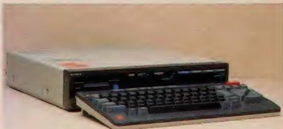
待望のディスクドライブ内蔵マシン。スーパーインポーズ機能、AVコントロール機能などを持ち、内蔵ソフト「HIT BITアート」はビデオへのインポーズを考慮した編集が十分に可能。セパレート型のキーボードはタッチもよくコンパクト。本体前面にはワイヤレスジョイスティック受信部も装備。RF、コンポジット、アナログRGBの3出力を持った多機能機種。
