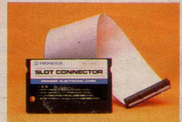
↑この端子にレーザーディスクを接続する。
