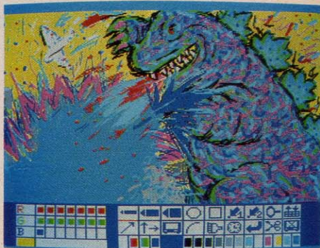
▲ スーパーインポーズされたときにV画面のパパとボクが入ることを想定して、左下を残してゴジラを描く。使用色表示は黄色。階調表示は、RedとGreenとBlueを7:7:1。カラーレベルを全て0にすると透明色ができる。そこにV画面が透過される。
