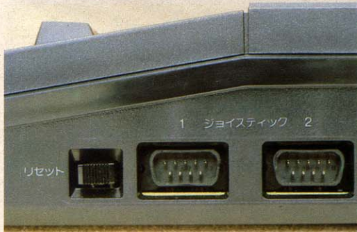
■本体右側面のジョイスティックポートとリセットキー。
