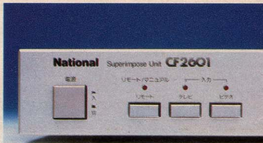
映像ソースの入力切り換え。テレビはRGBの入力。
