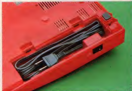
●本体底部にある、電源コードの収納スペース。スッキリとコードを収めて、街中をコンピュータ片手に歩き回ります。
