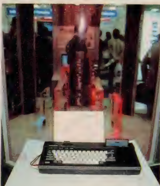
◆YAMAHAのMSXマシンを使ってシンセサイザーとレーザーを制御。ファンクションキーを押すとシンセの音楽が流れ、レーザーが飛び交うのだ。
