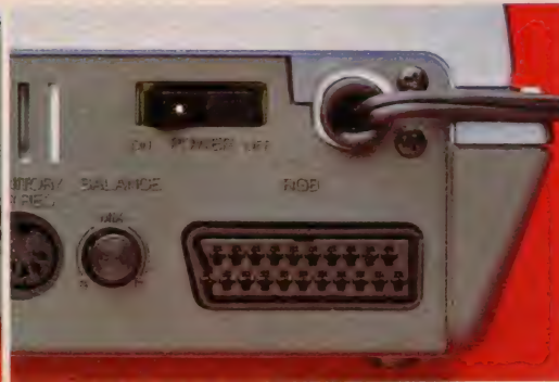
↑RGB出力は、アナログ21ピン対応。これを使うことで、スーパーインポーズが可能になる。左は音声ミキシングボリューム
