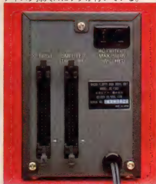
右がコンピュータとのコネクタ。左は増設用ディスクドライブにつなぐ。
