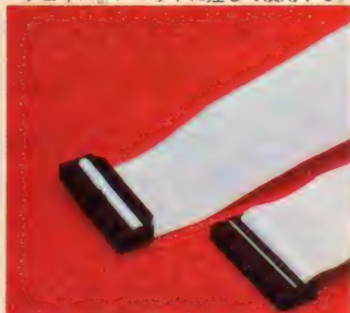
ディスクドライブ付属のフラットケーブル。ドライブを増設するときにも使う。
