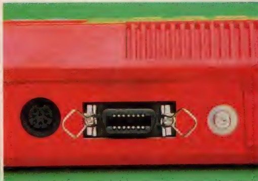
●カセットインターフェイスと、プリンターフェイス。アース端子が付いていることに注目！MSXは家電品です。
