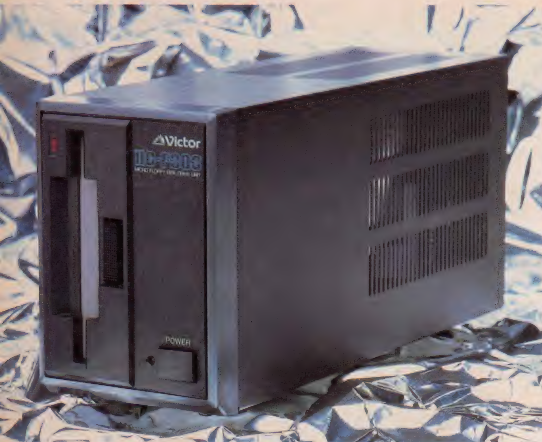
ヘッドをゴミやホコリから守るために、ディスク挿入口にフタが付いている。
