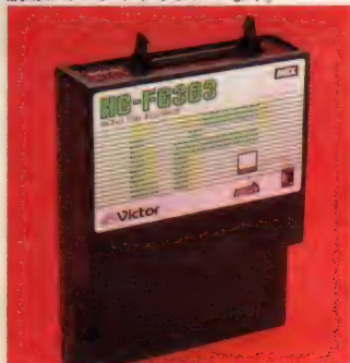
これがディスクコントロール用のインターフェイス。スロットに差し込んで使用する。
