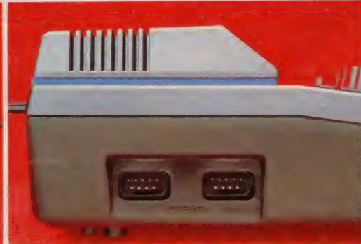
↑左側にある、2つのジョイスティックポート。ゲームの興奮を盛り上げるには、ジョイスティックは必携のアイテムです。
