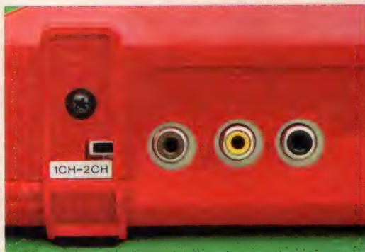
●モニタとの接続は、RF出力とコンポジット出力。この面を底にしても置けるように、端子類が上手く処理されている。
