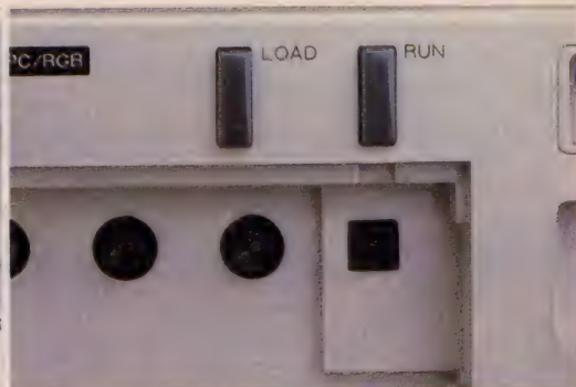
▲キーボードが無くても安心。"LOAD" "RUN"の各スイッチ。下にある4角いスイッチはリセット。通常はフタに隠れています。
