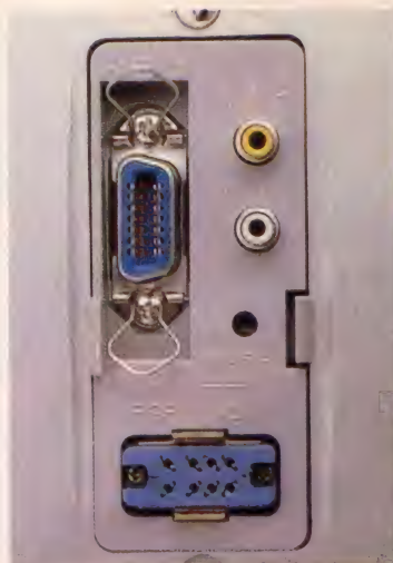
▲テレビの後面にある端子たち。RGBは8ピン対応、ビデオはAVというスイッチで選択できる。プリンタインターフェイスも内蔵。
