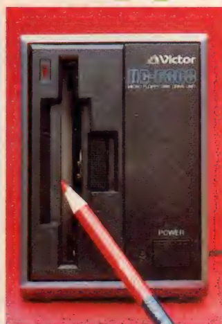
ヘッドをゴミやホコリから守るために、ディスク挿入口にフタが付いている。
