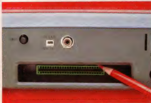
↑スロットは後面と側面の2つ。上にあるのがR F出力と、色相調節つまみ。このあたり、いかにもAVパソコンらしい構造だ。
