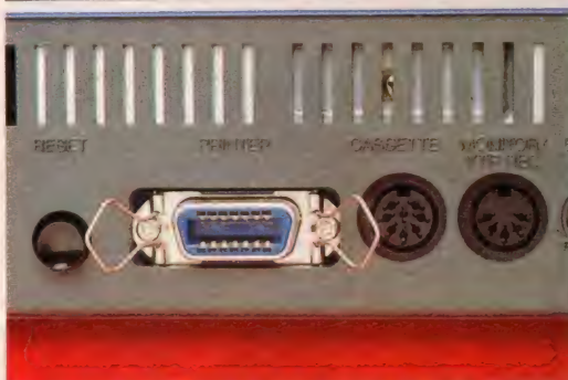
↑左から順に、リセットスイッチ、プリンターフェイス、カセットインターフェイス、ビデオ・サウンド出力端子
