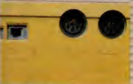
▲ビクターHC-6。「PRINTER」の表示は、プリンタインターフェイス。「MONITOR」の表示は、ソニーHB-75とは別のタイプのコンポジット出力です。HB-75は2本のケーブルで接続するのに対し、HC-6は1本のケーブルで接続します(ただし、先は2本に別れていて、やっぱりテレビの映像、音声の入力端子とつながります)。
