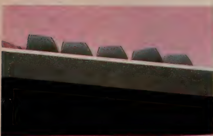
▲ステップスカルプチャータイプのキー。
