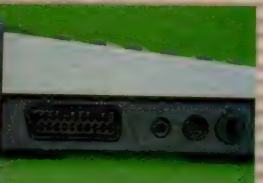
▲富士通FM-X。8ピンのTTLレベルRGB出力端子です。入力端子はFM-7との接続に使います。
