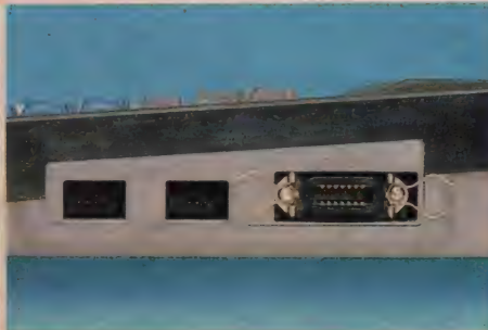
↓本体右側面に設けられたプリンタインターフェイス
