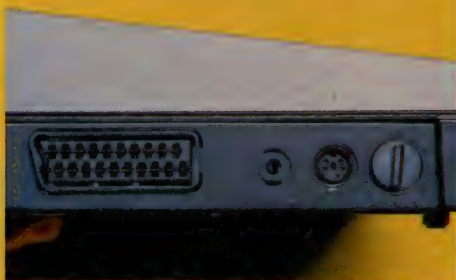
▶本体左側に左からRGB、VHDSYNC、VTR、REC、BLANCEの4種類の端子が用意されている。
