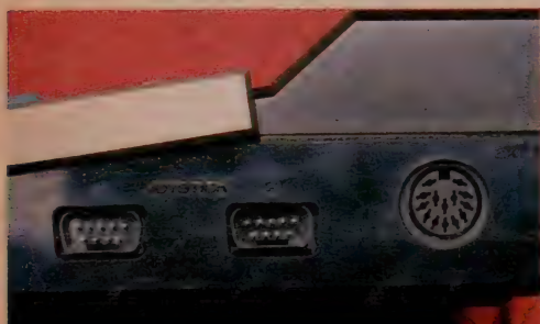
◆右にあるのはテンキーのインターフェイス。マシン語入力 が楽になる。ジョイスティックは2本まで接続可能。
